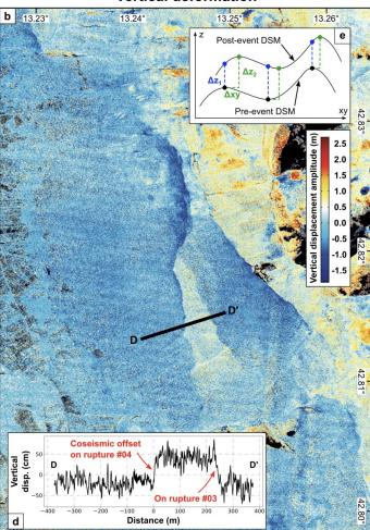
Reconstitution des décalages cosismiques sur la faille, en complémentarité des mesures de terrain.
