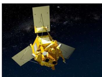
Les principales caractéristiques des instruments optiques, constitués de deux télescopes Korsch identiques, à bord de SPOT-6 et SPOT-7 fournissant une fauchée de 60km permettent d'acquérir des images avec une capacité de revisite quotidienne (angle de vue  $>45^\circ$ , opéré simultanément des deux satellites).
