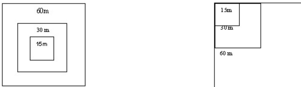
Figure 1 : Illustration d'un calage centre-pixel (à gauche) et bord-pixel (à droite).
