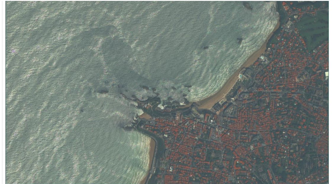
Figure – Exemple d'image présentant un scintillement important limitant la capacité des algorithmes à détecter automatiquement les navires
